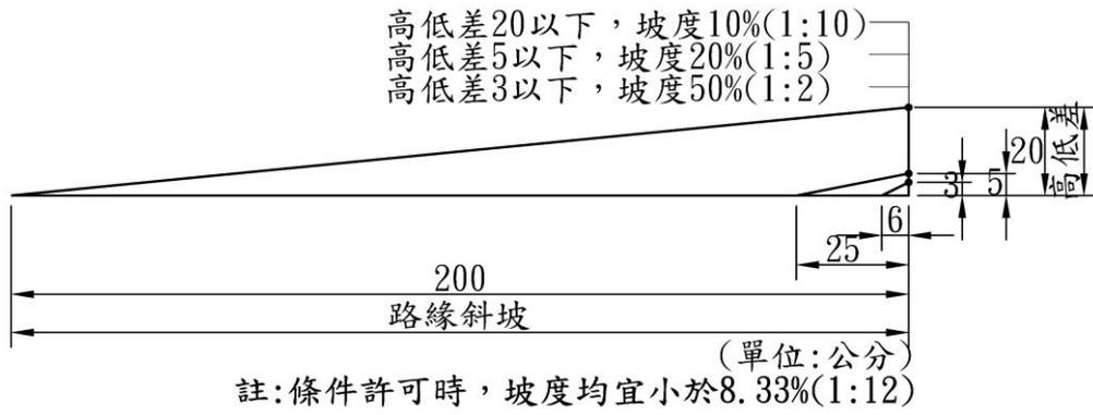
圖 14.2.4 路緣斜坡最大容許坡度參考圖
