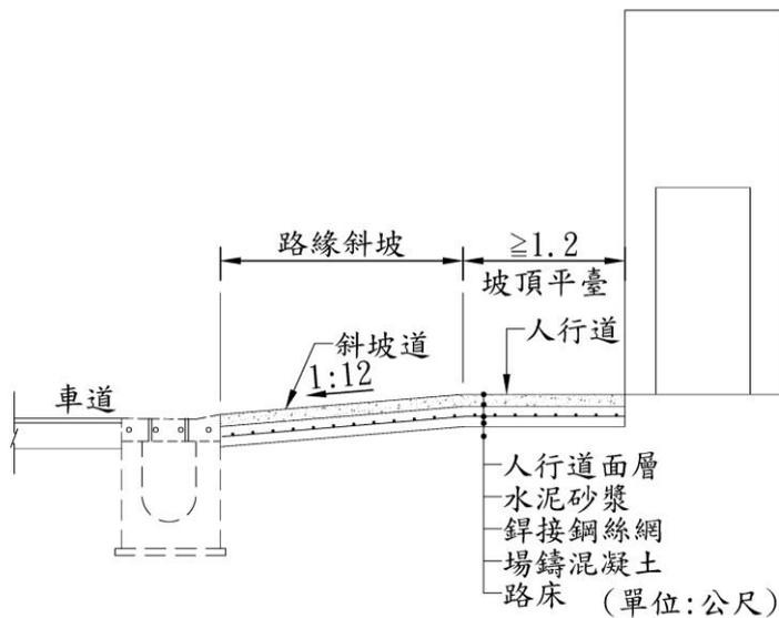
圖 14.2.3 路緣斜坡設計參考圖 (橫斷面)
